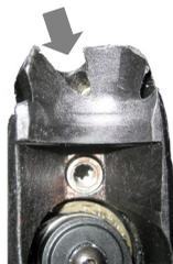
シフトケーブルを内側ルート(矢印)に設置する場合、ブラケットのアウトター受け部分が非常に浅いので、確実にアウトターが、奥まで挿入されているか確認して、作業を進めてください。
