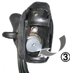
②2.5mmの六角レンチでプーリー取り付けネジをはずします。次に、既存のプーリーをラジオペンチなどで、真っ直ぐに静かに外します。
