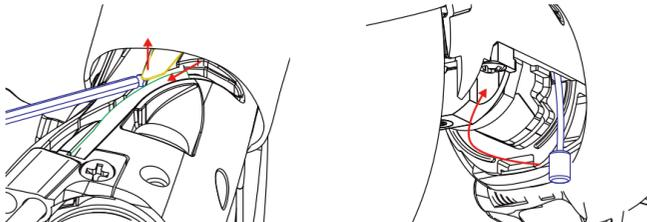
シフトケーブルをディレイラーに固定し、再度ケーブルエンドが正しく差し込まれていることを確認してからアンダーカバーを取り付けてください。
