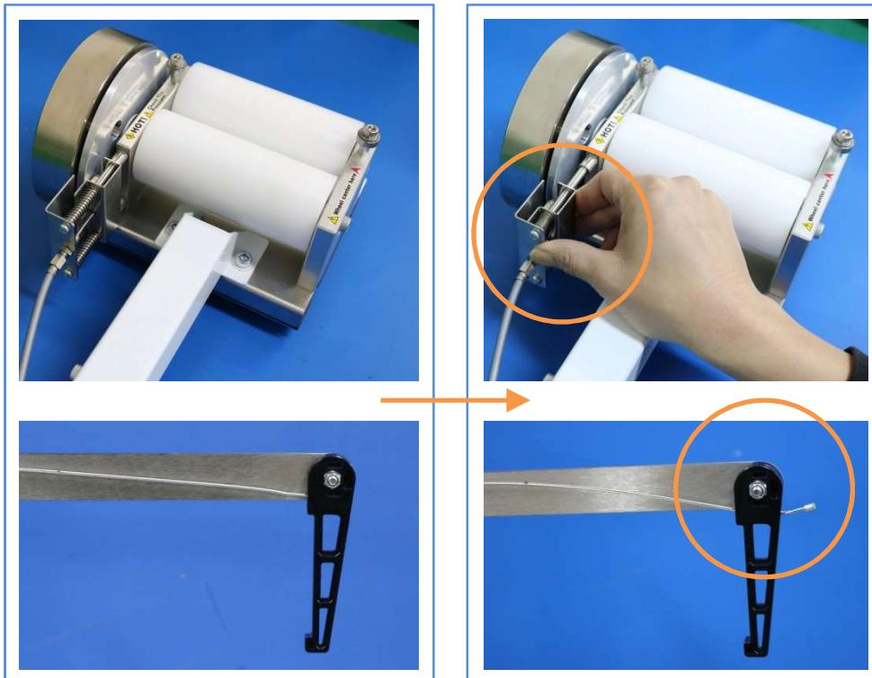
3. ワイヤーの頭を負荷調整レバーの下の穴にずらし、リアユニットを戻しながら、ワイヤーを抜きます。
