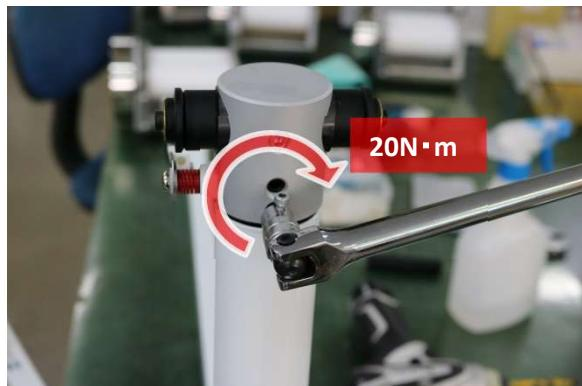
注意: 締め付けが弱いと転倒につながり危険ですので、締め付けトルクを守りしっかりと締めてください。交換後は、ボルトの緩みがないか定期的に確認してください。
