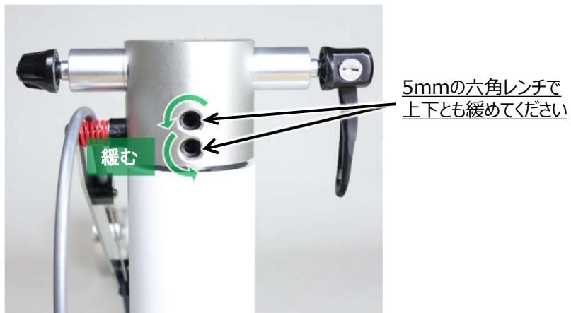
MCを固定しているネジは非常に固く締まっており、力が必要な作業になりますので、ケガなどにご注意ください。作業には下図のような柄が長く、力の入りやすい工具をお勧めします。
