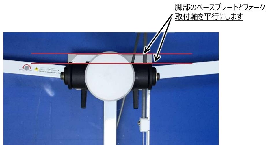
8. 2本の止めねじを均等にしっかりと締めます。(締め付けトルク:20N・m)
