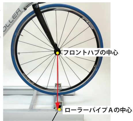
ローラーパイプ A の中心がフロントハブの中心よりも 15mm 前方にある
