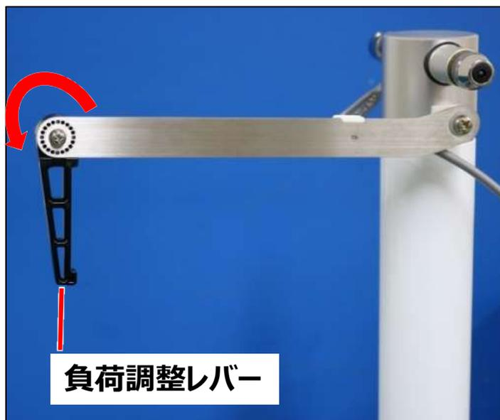
2. 負荷操作用ワイヤーが少したるむ程度に、マグネットホルダーを指でつまむように矢印方向に少し動かしたまま、次の手順に移ります
