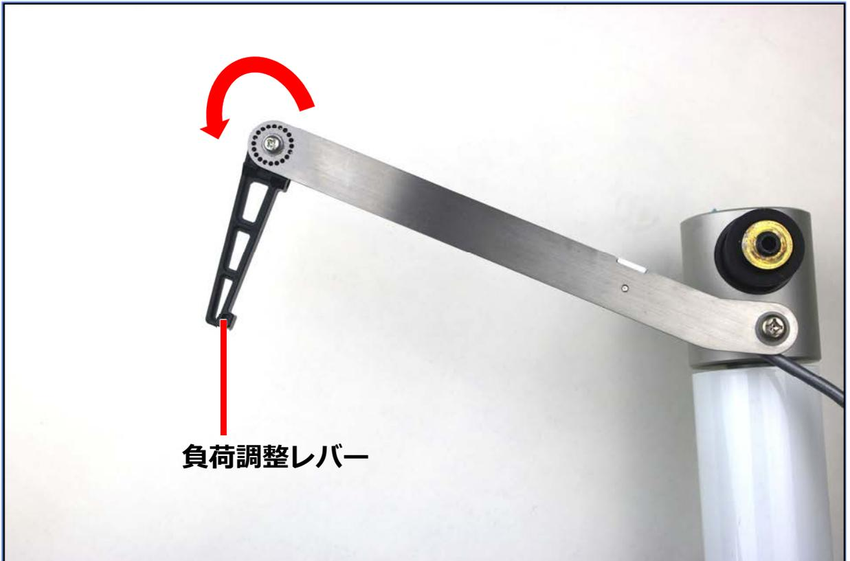
3-2. 負荷操作用ワイヤーが少したるむ程度に、マグネットホルダーを指でつまみ、矢印方向に少し動かしたまま、次の手順に移ります
