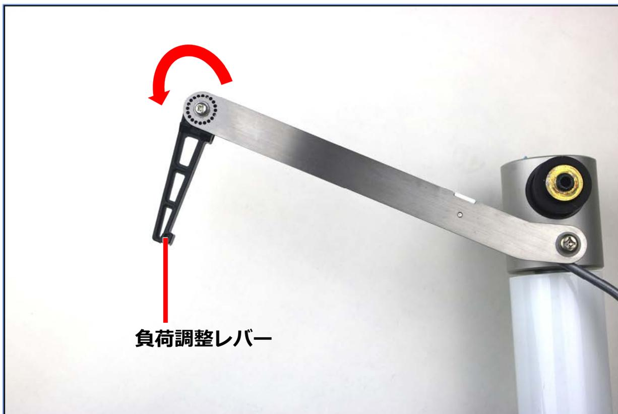
1-2. 負荷操作用ワイヤーが少したるむ程度に、マグネットホルダーを指でつまみ、矢印方向に少し動かしたまま、次の手順に移ります
