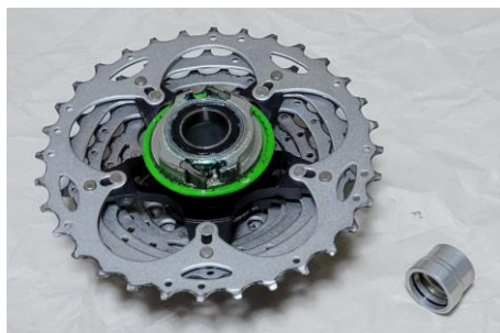
抜け落ちたスプロケットとフリーボディ(イメージ)
