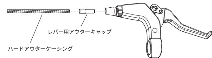
ハードアウターケーシングのみ使用することを推奨しますが、ハードアウターケーシングでは反発が強くハンドリングに影響が出る場合は、ドロップハンドル時と同様にソフトアウターケーシングも使用してください。
