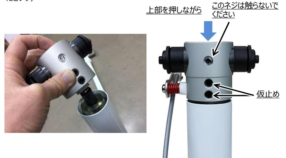
7. MCの上から覗きこみ、フォーク取付軸と脚部ベースプレートを平行に合わせます。
