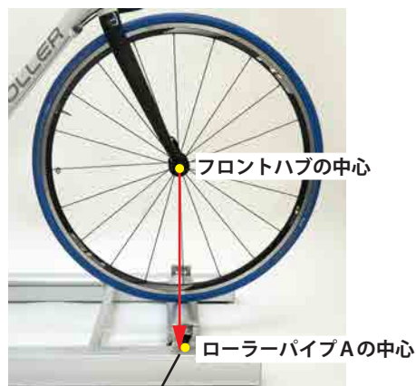
ローラーパイプAの中心がフロントハブの中心よりも15mm前方にある
